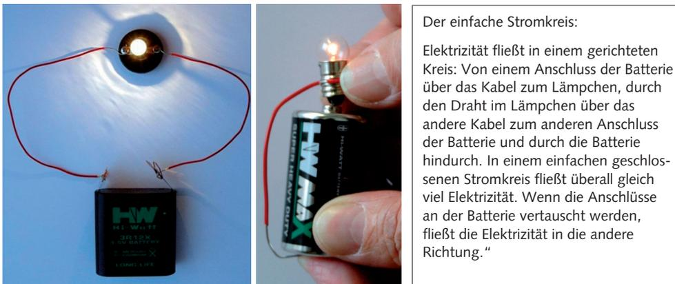
Abb. 2a und b: Einfacher Stromkreis – zwei Möglichkeiten des Aufbaus
